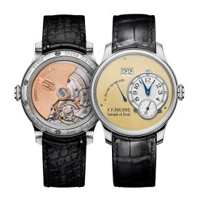
2001 年推出的 Octa 自動上鏈機芯標誌著鐘表史上的一個轉捩點,它證明了 21 世紀的製表革命經已展開。這枚高性能的機芯在面世以後的 20 年間僅經歷了 3 次演變。最近一次為上鏈系統的優化,將它由雙向上鏈及為單向上鏈,這改動確保擺陀轉動所產生的能量能更快速地將發條上緊,令機芯運作更具效率。
